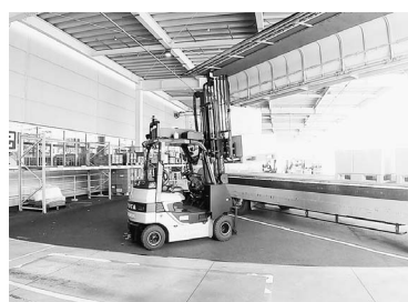
自動運転フォークリフト
